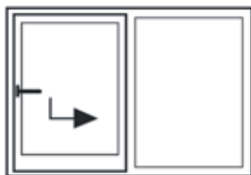
Схема А 2-створчатая конструкция: 1 подвижная створка, 1 глухая створка
