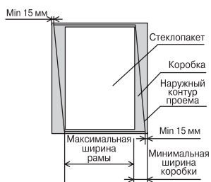
Рис. 10. Определение размеров окна при перекосах проема
